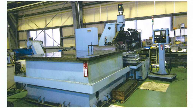
ガンドリルマシン KKG-1500 テーブル寸法 X2000 Y2000 ST X2000 Y200 Z1500 加工穴径 \phi 4 \sim \phi 30 主軸回転数 8000r.p.m 最大加工深さ 止り穴1500mm 貫通3000mm
