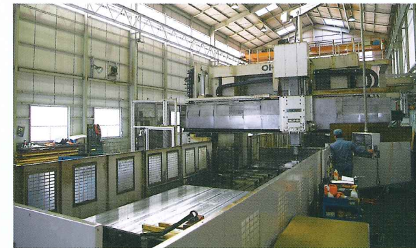
五面加工機 MCR-BII ST X8000 Y3000 Z800 横ケタST 1200mm 主軸 8000r.p.m仕様 ユニバーサルヘッド 1度割り出し アングルヘッド 1度割り出し
