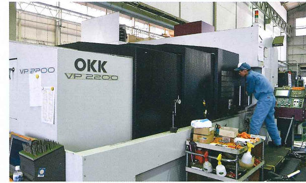
高速マシニングセンター VP-2200 ST X3050 Y2200 Z460 ATC 120本 主軸 20000r.p.m アルミ加工専用機
